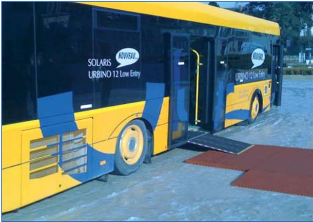
Bus interurbain à plancher bas avec palette et éléments modulables
