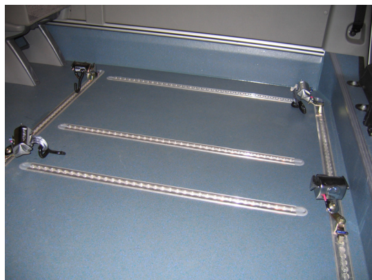
Rails d'ancrage et sangles à crochets pour fixation au fauteuil
