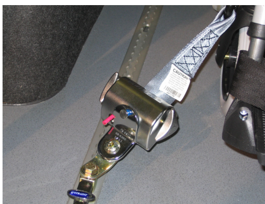
Dispositif enrouleur de sangle d'arrimage
