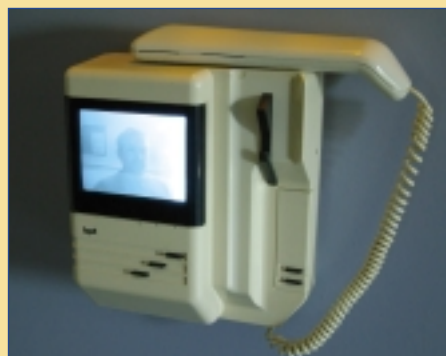
Intercom vidéo (vue de l'appartement)
