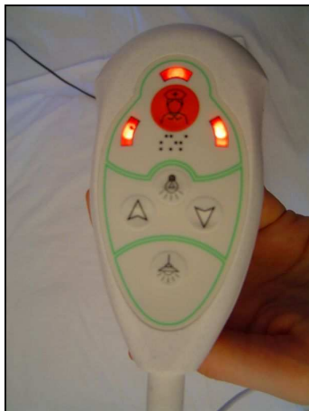
Bouton d'appel infirmière munis de contacteurs en relief, de témoins lumineux et transcrits en braille.
